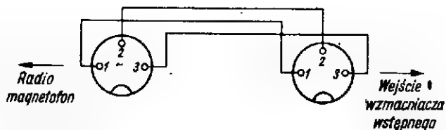
Rys. 7. Połączenia kabla łączącego wzmacniacz z radioodbiornikiem lub magnetofonem
