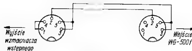
Rys. 8. Połączenia kabla łączącego wzmacniacz z wejściem zestawu WG-500 f
